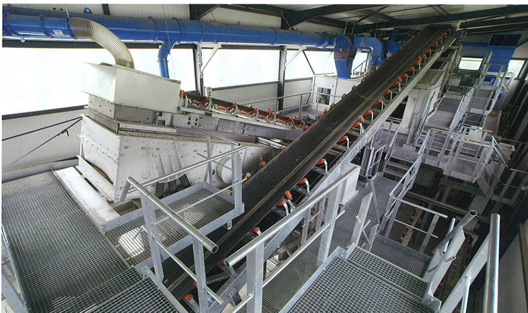
Siebmaschine mit integrierten Windsichter, Fördertechnik, Entstaubungsanlage.
