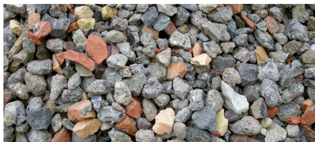
ECOBETON® non classé: RC-M 100% graviers recyclés béton + mélangés
