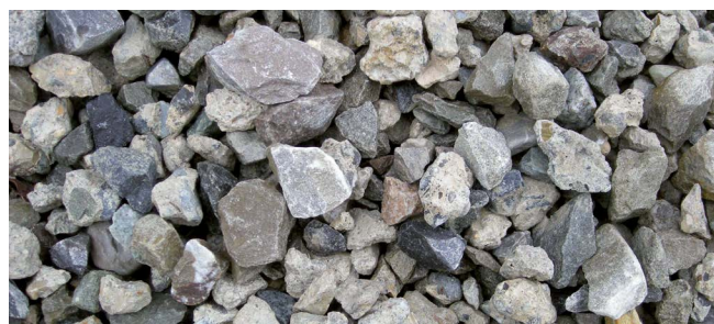
ECOBETON® classé Min. 25% de graviers recyclés béton, jusqu'à 50%
